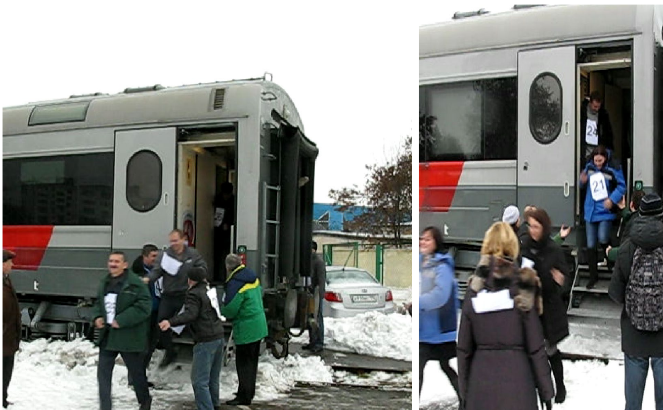
Рисунок 2.2 – Общий вид эвакуационного выхода и трапа
