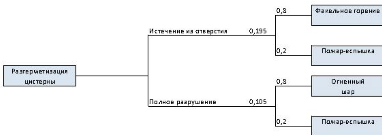
Рисунок 3.1 – Дерево событий при разгерметизации автоцистерны с СУГ
